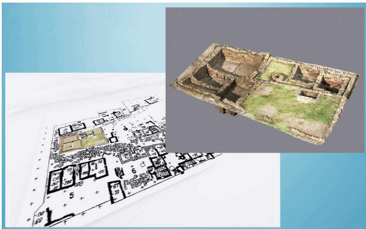
Рис. 8. 3D-модель участка Анапского заповедника, полученная с помощью технологий фотограмметрии (программа Agisoft Photoskan)
